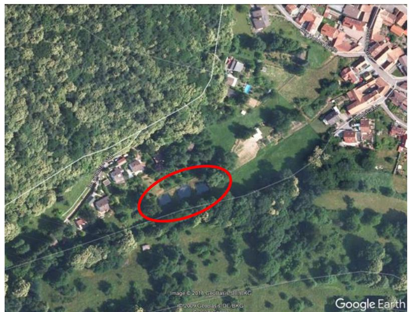
Die Fischteichanlage besteht aus drei Einzelteichen, die von West nach Ost kaskadenartig mit einem Höhenunterschied von jeweils ca. 2 m (grobe Schätzung) untereinander liegen. Der Damm des unteren Teichs (Bild unten) liegt etwa 2 bis 3 m über dem Gelände.
