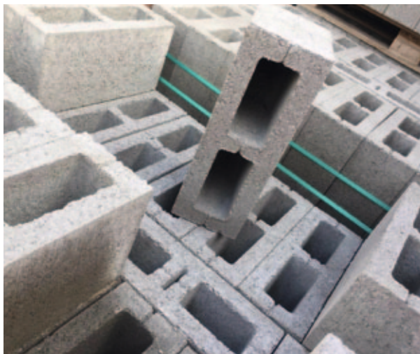
Leichtbeton-Hohlblöcke für die Verwendung im Mauerwerksbau
